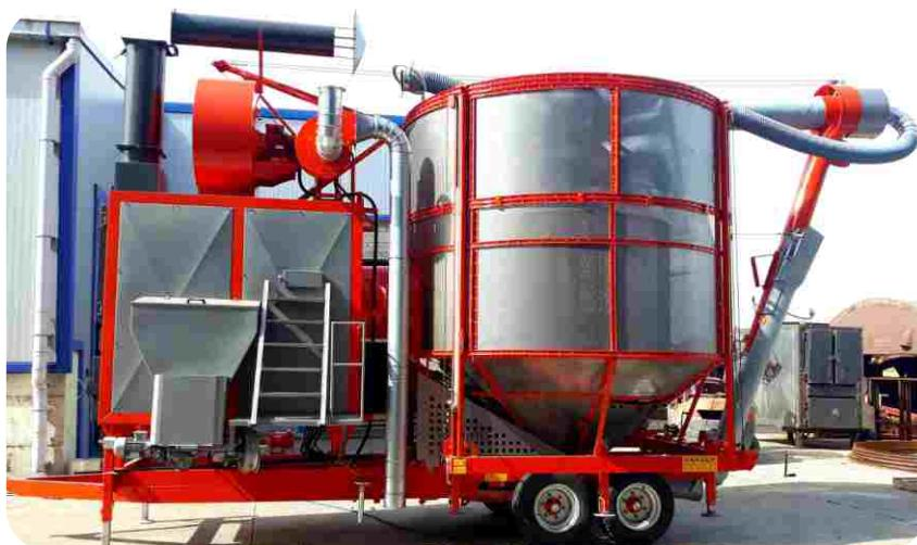
**Yatay ve Dikey Tip Kurutma Makineleri;** Hububat tarzı mahsüllerin kurutulmasında kullanılır. (Mısır, çeltik, ayçiçeği vb.)
