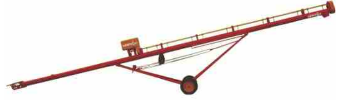
16,5 cm Çapında Elektrik Motoru ve Kuyruk Mili Tahrikli Helezonlu Götürücü
